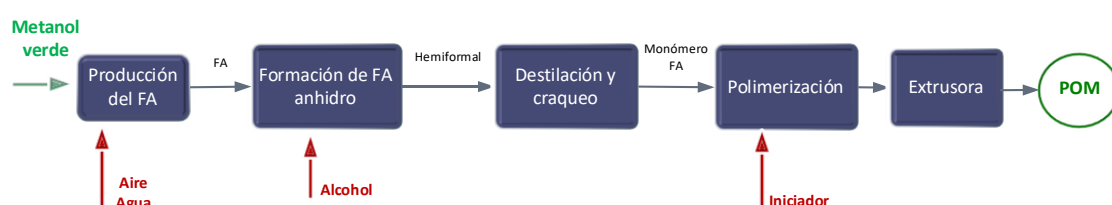
Figura 9 Esquema del proceso de producción de POM
